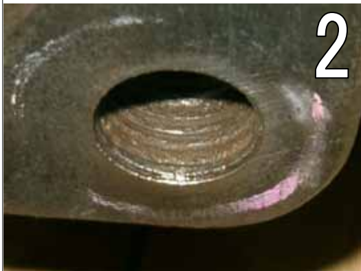
ネジ山損傷部拡大
