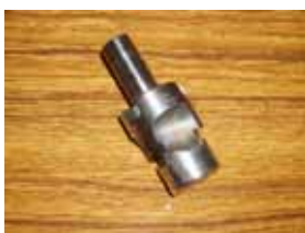
FST Style インサートSpotfacer
