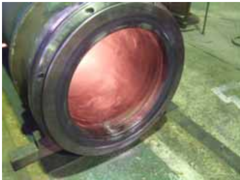
内径520mm,長さ2400mmのシリンダライナー
