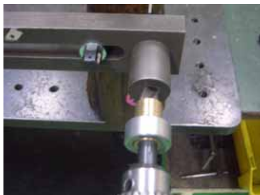
外側に力が掛からないように慎重に穴加工
