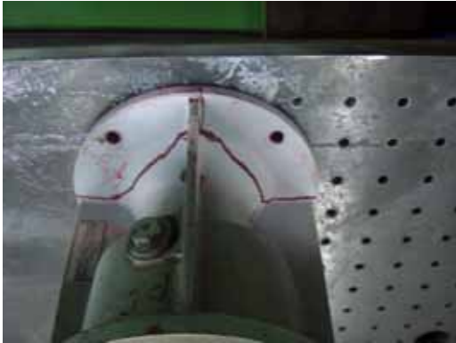
鋳物モーターカバーの内外面貫通亀裂
