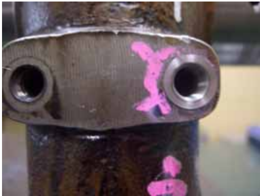
インサート施工 肉薄でも内側に働く引張力により 施工が可能
