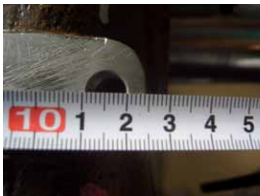
外側の肉厚が4mmしか無く、オーバーサイズで加工しボルトを挿入するとネジ穴が破損する可能性がある
