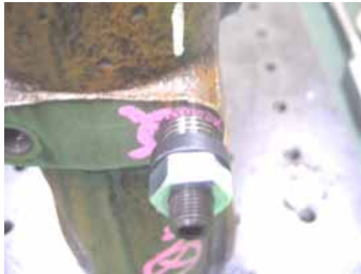
治具を用いてインサートを挿入
