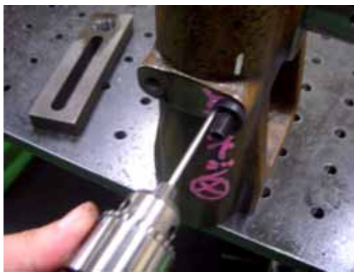
インサートと母材との境界部に 周り止めピン施工
