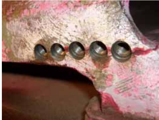
亀裂に沿ってネジ孔加工
