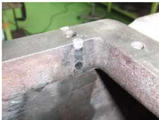
ボルト穴付近のクラックを補修
