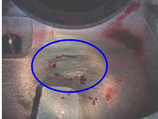
カラーチェック（円弧状に亀裂発生）
