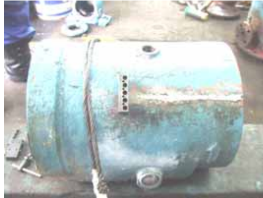
クラック端部に穴加工用治具設置
