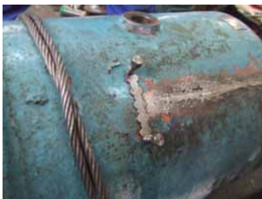
補強材の両端に抜止めピン施工
