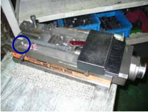
バイスのワーク固定用ねじ穴が破損
